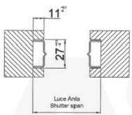
Determinazione della lunghezza delle lamelle: Luce anta - 33 mm
