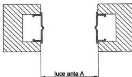
. DETERMINAZIONE DELLA LUNGHEZZA DELLE LAMELLE: luce anta (A) - 13.5 mm
